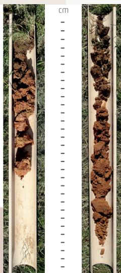
Tassement du sol relevé à partir de 20 cm dans l'inter-rang enherbé et dès les 1<sup>ers</sup> centimètres sur la ligne de plantation. ⚠
